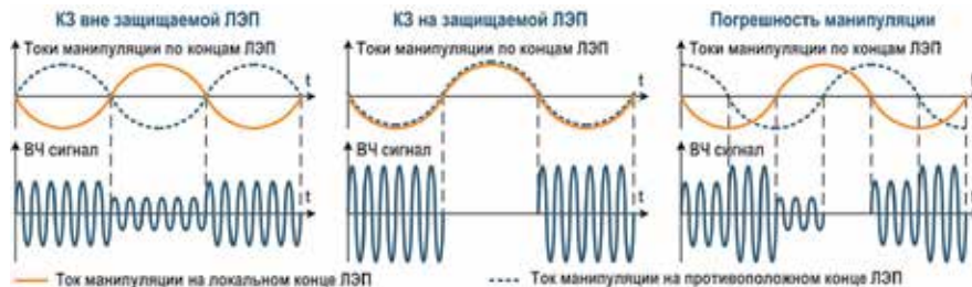
Рис. 2. Амплитудная манипуляция в ВЧ аппаратуре ДФЗ
