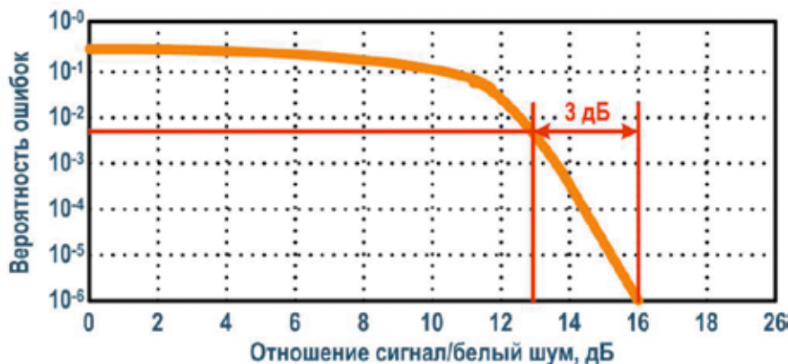
Рис. 7. Пример зависимости вероятности ошибок в ЦВЧ канале от ОСШ
