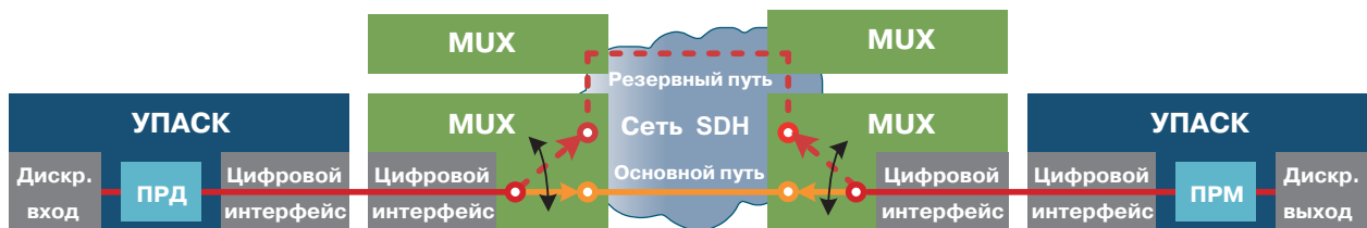
Рис. 1. Механизмы резервирования сетей SDH/PDH для канала УПАСК
