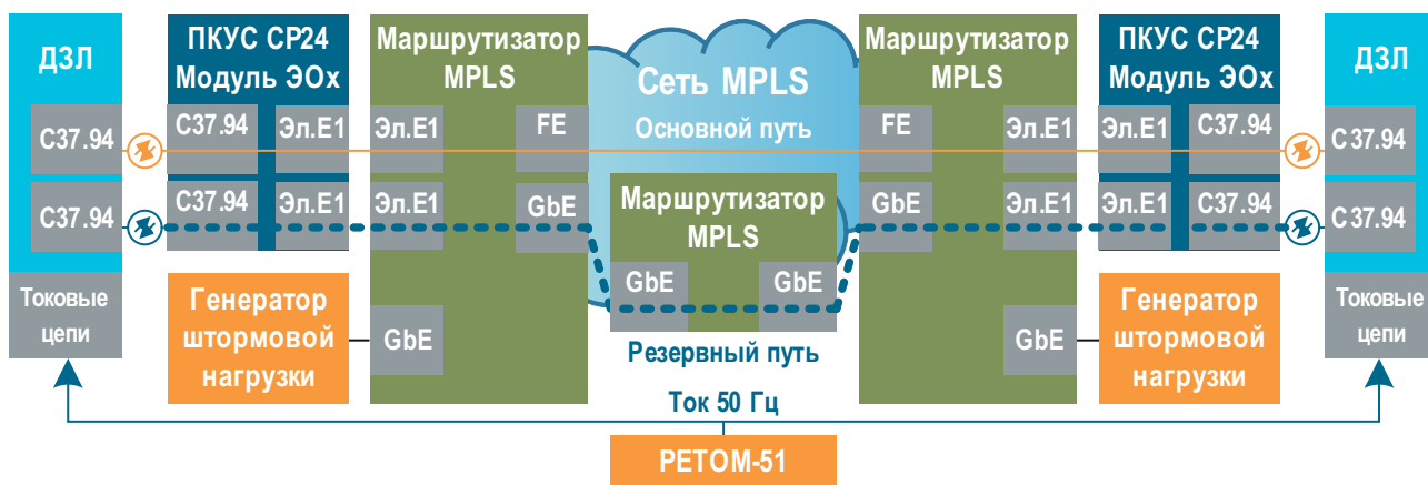
Рис. 9. Подключение терминалов ДЗЛ к сети MPLS с прогрузкой токовых цепей для оценки влияния асимметрии каналов на погрешность вычисления дифференциального тока
